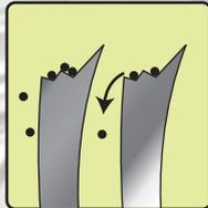
シャークタイプセニングの抜群の切れ味と柔らかさを生み出す秘密。それはまず特徴的な鋭い牙のようなクシ刃の先端にあります。髪の毛に対して自然なクシ刃の入りをエスコートするとともに、切れ刃に対して適切なクリアランスをコントロールします。そして先端に向かって下がっていく溝構造は、髪の毛を適度に逃がす効果があり、カット時にかかる負荷を軽減。髪の毛を1本1本ポイントで切るので、カット断面はより美しくなり、枝毛になりにくく、そしてカットラインが目立ちにくい自然な仕上がりを生み出します。さらに、広くなったクシ刃の根元は、髪の毛の通りを妨げず、抜群の抜けを実現。現在考える毛量調整のセニングにおいて最上クラスの性能を持ったシザーです。
